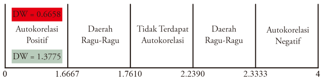
Gambar 4.14. Uji Durbin Watson Autokorelasi Model Ketimpangan Pendapatan
